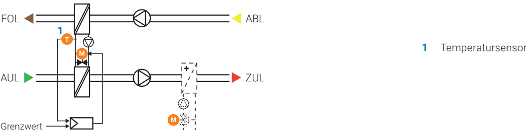
Bild 76: Schema Vereisungsschutz KVS
