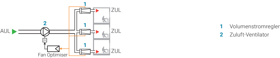
Bild 79: Schema Fan Optimiser
